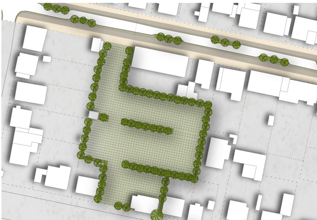
Figur 12. Blå-grønne løsninger på parkeringspladsen ved rådhuset, hvor befæstelsen kan udføres som en permeabel grøn belægning.
